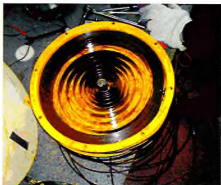
Рис. 5. Пружина барабана ограничителя AML фирмы TADANO
