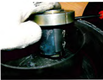
Рис. 2. Крепление пружины ко втулке ОНК-140
