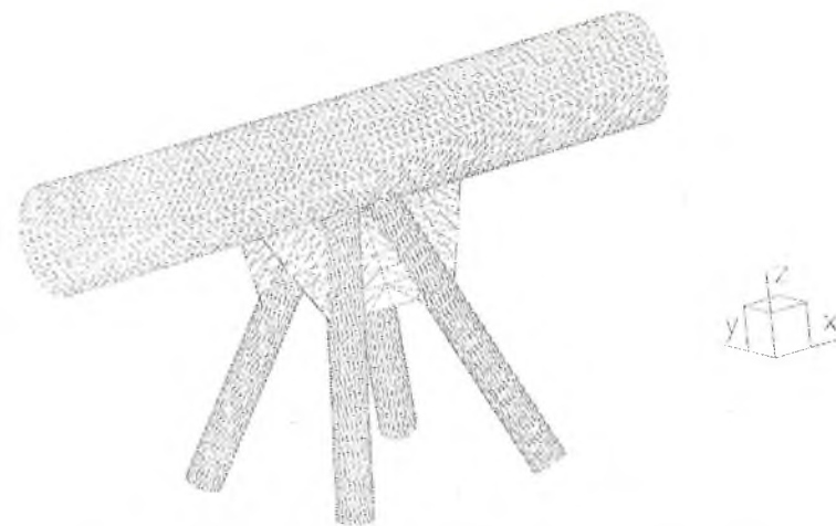
Рис. 2. Расчетная модель узла фермы с внутренними и внешними косынками.
