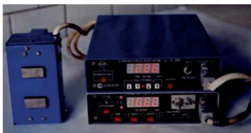
Рис. 33. Внешний вид двух импульсных структуроскопов КРМ – Ц – К2м
