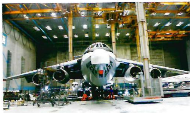
Рис. 8. Элементы безопасности – перила и надувные бамперы на платформах
