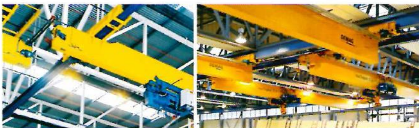
Рис. 5. Стыковка и расстыковка секций кранов в работе
