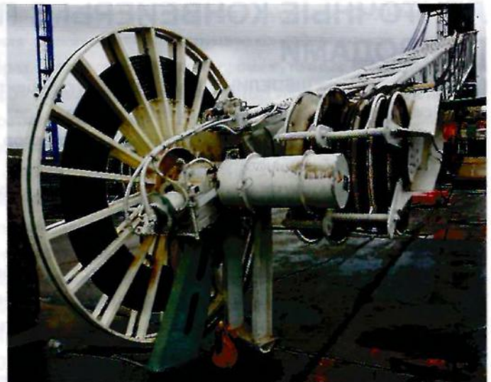
Рис. 7. Кабельный барабан с гидроприводом на стреле портowego крана – перегружателя
