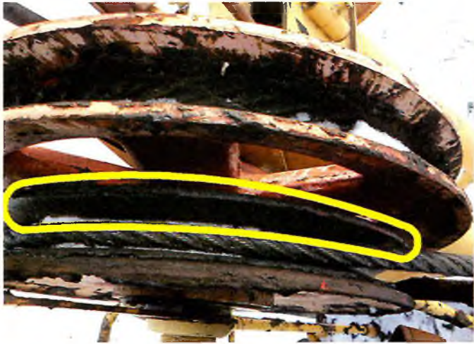
Фото 3. Оборванный конец каната стрелового расчала
