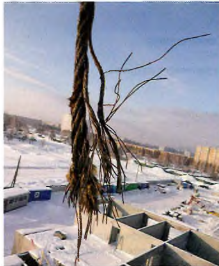
Фото 3. Оборванный конец каната стрелового расчала
