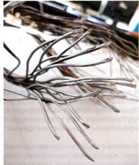
Фото 4. Характер перетирания проволок каната стрелового расчала
