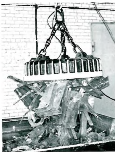
Рис. 8. Электромагнит ЭМГ 165-42/А, масса магнитопровода 2100 кг, груз скрапа 970 кг
