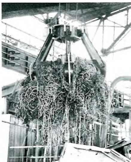
Рис. 2. Грейфер 10-Л2то-М-В производства ООО «Димет-М» с грузом лома 16А
