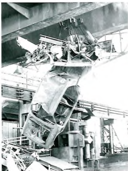
Рис. 1. Грейфер 10-Л2то-М-В производства ООО «Димет-М» с грузом лома 12А
