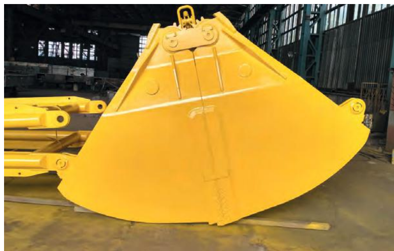
Рис. 1 Грейфер с ножами из стали 10ХСНД с наплавкой твердосплавными материалами
