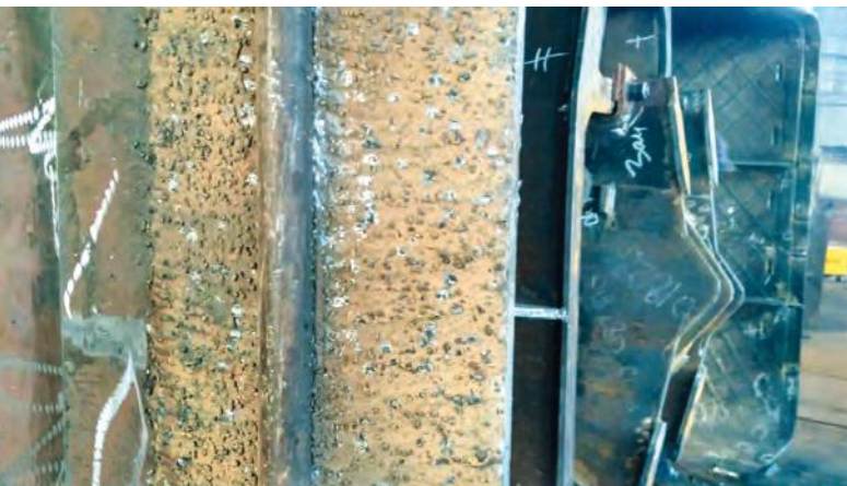
Рис. 1 Грейфер с ножами из стали 10ХСНД с наплавкой твердосплавными материалами
