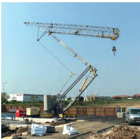
Самомонтирующийся башенный кран фирмы Mantis модели 3510. Длина стрелы-35 м, максимальная высота подъема-21,7 м, максимальная грузоподъемность-4 т.
