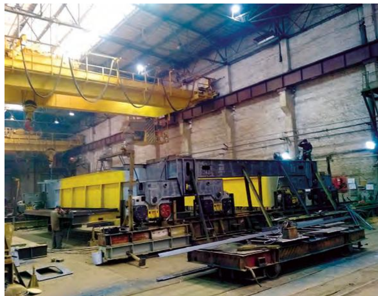
Сборка моста крана г/п 125т в стапеле
