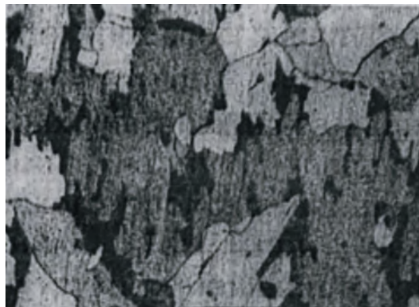
Рис. 8 Микроструктура металла сварного шва в результате пережога при изготовлении (увеличение x 100)
