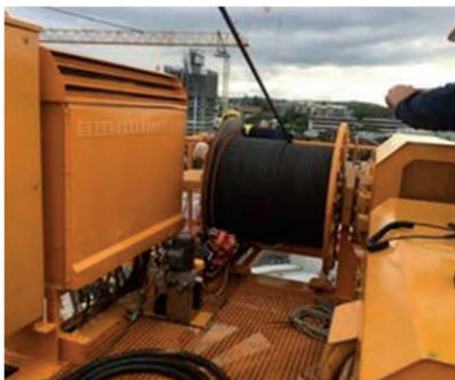
Общий вид грузовой лебедки с установленным на ней вторичным тормозом
