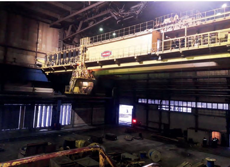
Кран клещевой специальный, г/п 105+105 т
