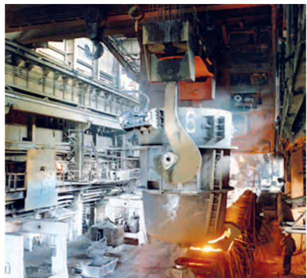
Рис. 36 Заливка жидкого чугуна с применением стопорного ковша в литейные формы
