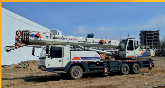
Автокран ZOOMLION після ремонту гідроциліндра висування стріли з наступною заміною гільзи
