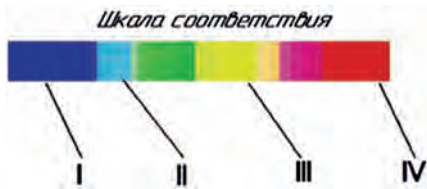
Рис. 43 Шкала соответствия изменений значений коэрцитивной силы ( H_c, \text{А/см} ) для стали 09Г2С.
