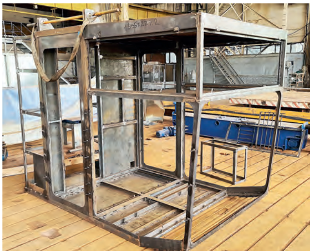
Рис. 6 Кабина в процессе изготовления
