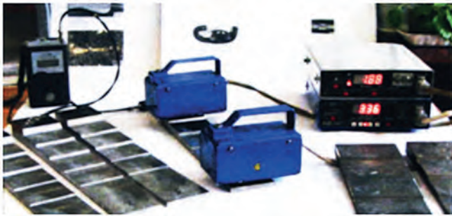
Рис. 46 Проведение сравнительных замеров H_c на образцах-эталонах (с переменным сечением) разными структуроскопами
