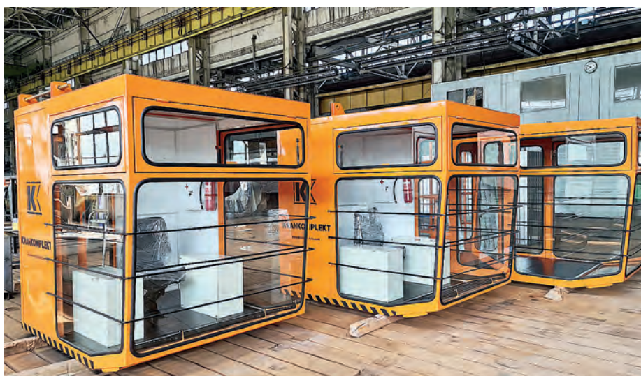
Рис. 7 Кабины после окраски
