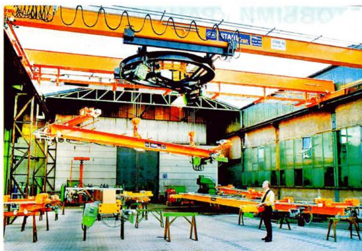
Рис. 3. Мостовой кран с поворотной тележкой и двумя независимыми грузовыми лебедками
