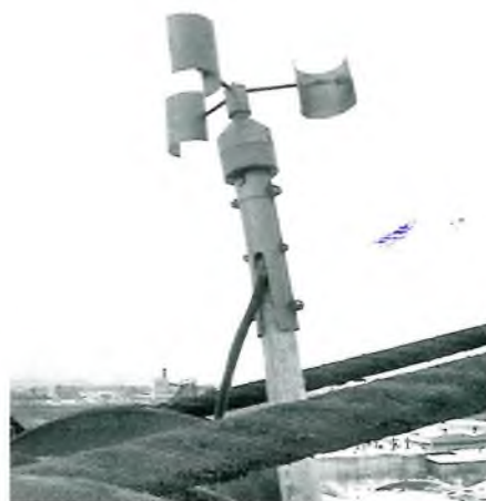
Рис. 2. Неправильная установка анемометра на кране С-981
