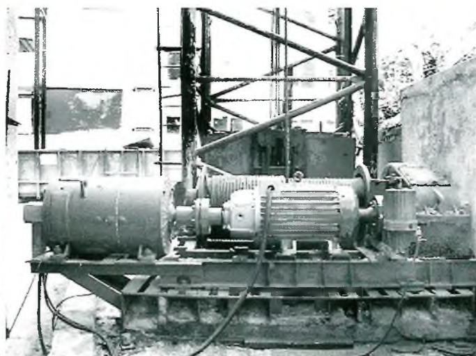
Стенд для испытаний электроприводов механизмов подъема
