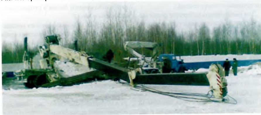
Рис. 1. Авария крана КС-55722-1, 2009 год
