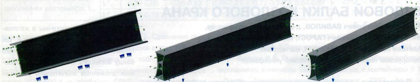
Рис. 4. Схемы закрепления ездовых балок слева направо: двутавровой; с криволинейными стенками; предлагаемой конструкции с изгибами на боковых стенках
