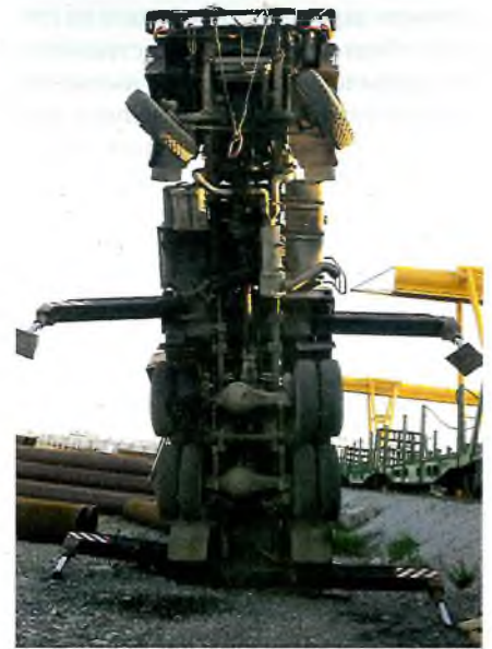
Рис. 1. Автокран с неисправным ограничителем грузоподъемности
