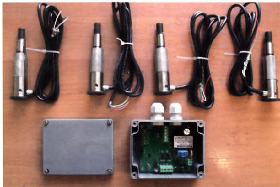
Четыре тензометрических датчика и нормирующий преобразователь НП-10Г
