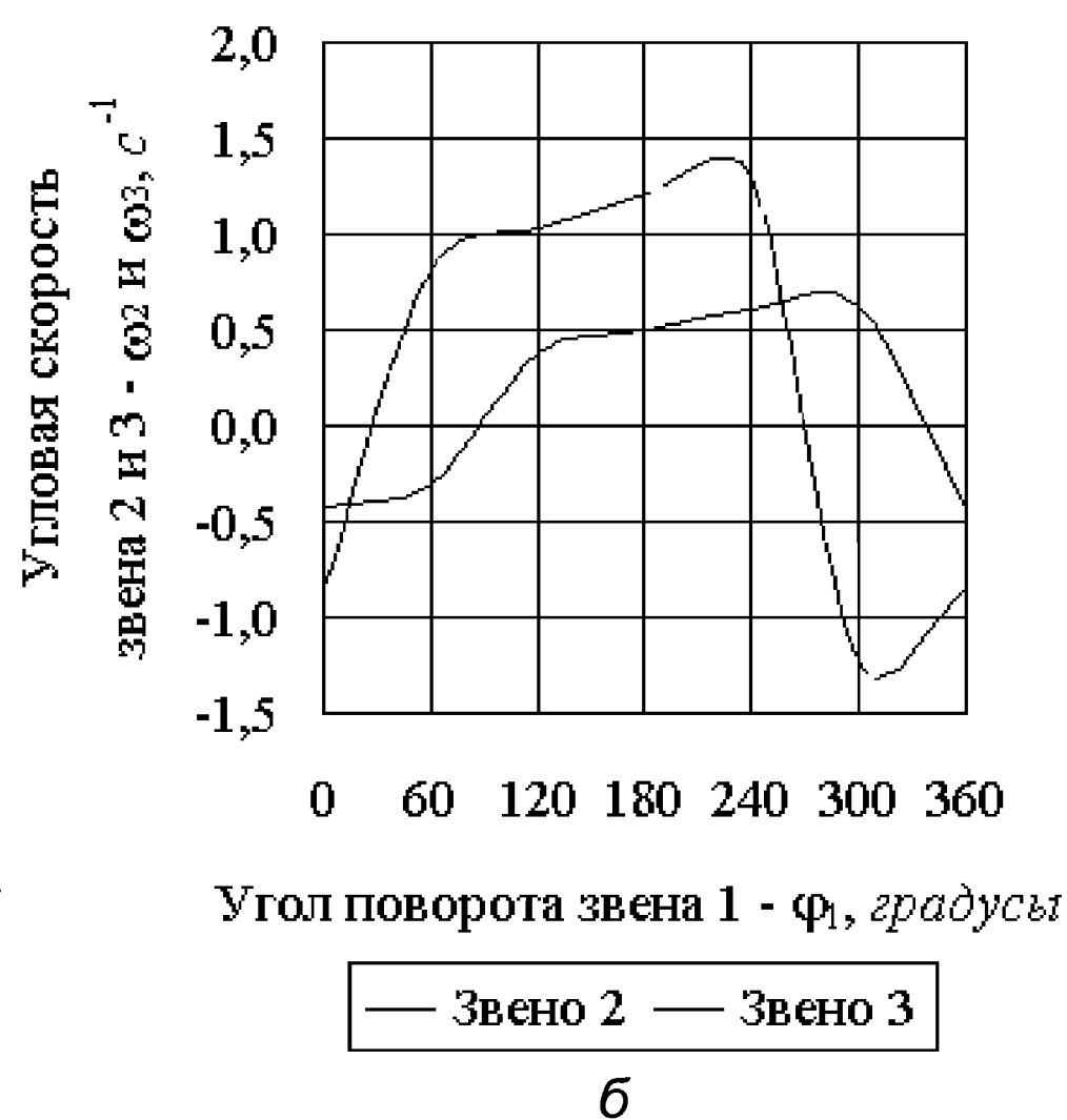
Рис. 2.15. Графики функций положения и скоростей звеньев 2 и 3 шарнирного четырехзвенного механизма
