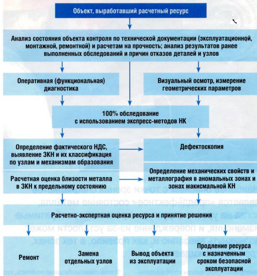
Рис. 1. Структурная схема определения остаточного ресурса оборудования с использованием экспресс-методов
