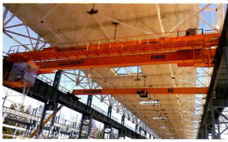
лее интенсивен. Установка крановых колес на осях, параллельность самих осей относительно друг друга и корпуса моста, параллельность и разновысотность рельсов, их кривизна и состояние требуют максимальной точности (труднодостижимой на практике), поэтому проектные (расчетные) сроки службы кранов и их узлов значительно отличаются от реальных.
