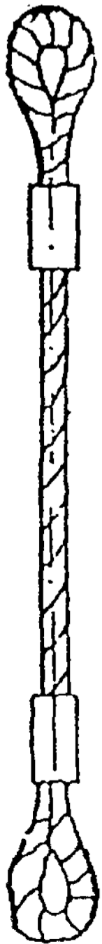
Канатная ветвь типа ВК с заделкой концов втулкой ГОСТ 25573-82 *
