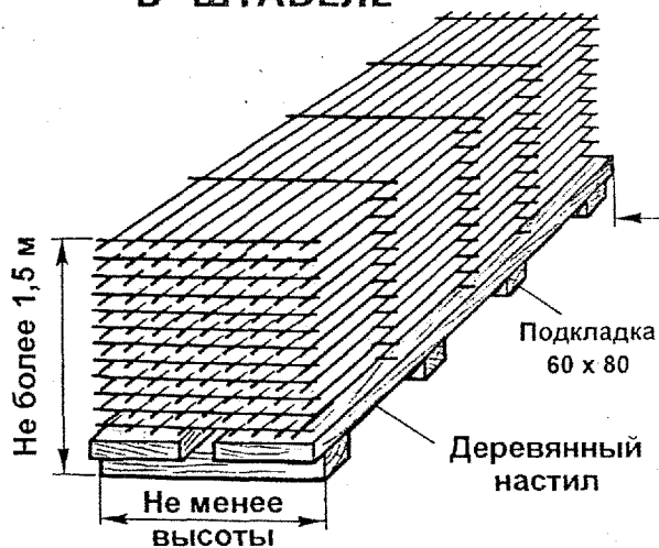
АРМАТУРНАЯ СЕТКА В ШТАБЕЛЕ
