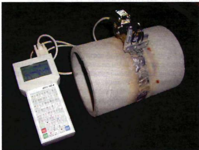
Рис. 1. Схема контроля стыковых сварных соединений труб многоканальным сканирующим устройством прибора ИКН: 1, 2, 3 – датчики сканирующего устройства для регистрации одновременно нормальной ( H_y ) и тангенциальной ( H_x ) составляющих поля на поверхности сварного шва; 4 – датчик для отстройки от внешнего магнитного поля; 5 – колеса привода измерителя длины; \Delta l_0 – базовое расстояние между датчиками.
