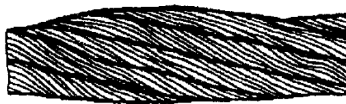
Рисунок 13. Местное увеличение диаметра каната
