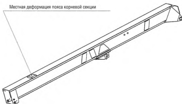
Рис. 1. Схема расположения локальной зоны перегрузки верхнего пояса корневой секции стрелы
