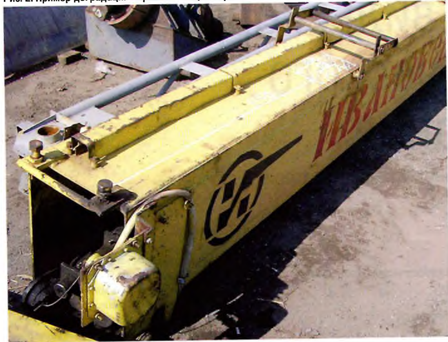
Рис. 2. Пример деградации корневой секции стрелы
