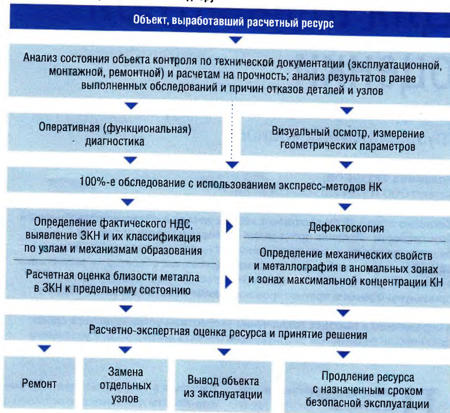
Рис. 1. Структурная схема определения остаточного ресурса потенциально опасных объектов, подконтрольных Ростехнадзору
