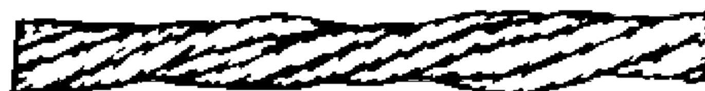
Рис. 7. Местное уменьшение диаметра каната на месте разрушения органического сердечника
