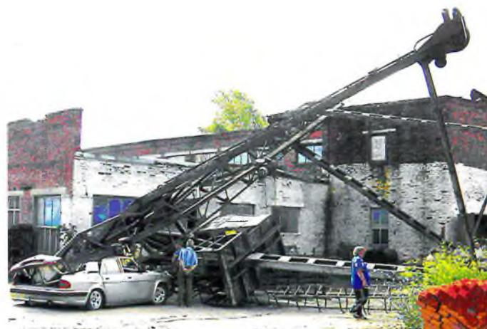
Рис. 5. Авария козлового крана грузоподъемностью 5 т
