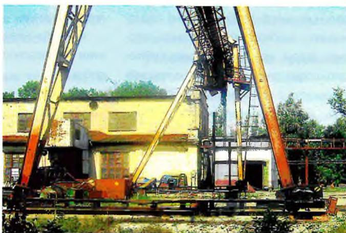
*Рис. 8. Повреждение металлоконструкции козлового крана КК-12,5-СМ25-9-1 в месте крепления моста и жестких опор*
