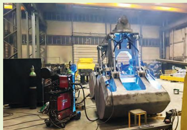
Гидравлические грейфера на участке сварки. Ковши изготовлены из материала Hardox500Tuf, режущие кромки – HARDOX500, коробка и поворотная голова – STRENX700
