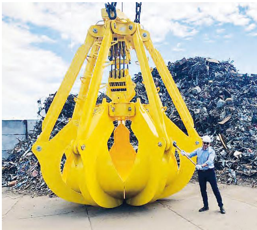
Основатель фирмы Хрущев А. В. у грейфера многочелюстного объемом 16м 3 для металлолома
