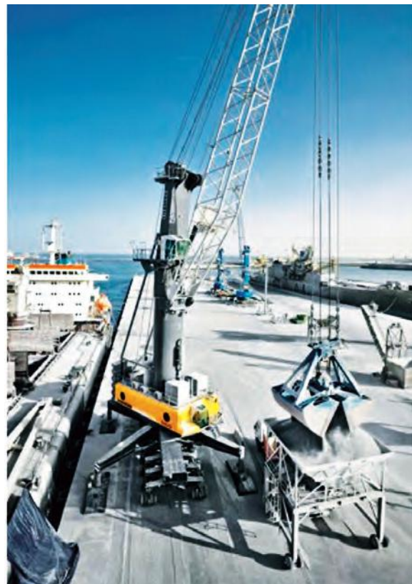
Рис. 11 Мобильный портовый кран Liebherr LHM 550 с увеличенной на 25% производительностью перевалки благодаря функции SmartGrip.
