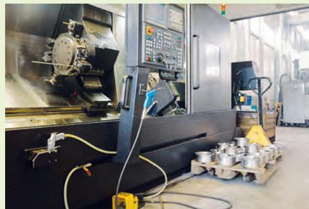
Обрабатывающий токарный ЧПУ станок DOOSAN Puma 1200XLY позволяет обрабатывать детали диаметром до 650мм и длиной 2100мм. Данное оборудование дает возможность гарантировать повторяемость процессов и значительно сокращает фактором связанные с человеческим фактором
