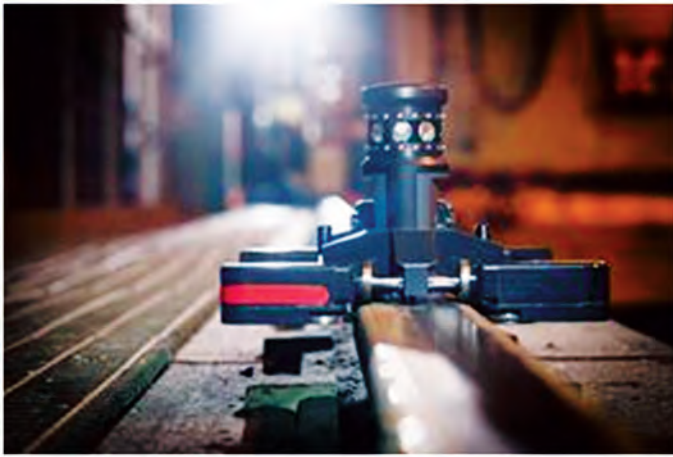
На работе RailQ устанавливается призма-отражатель, с помощью которой осуществляется лазерное сканирование поверхности подкрановых путей.
