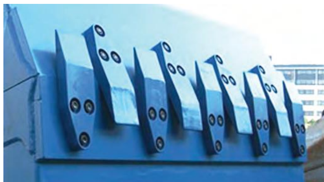
Рис.3 Двухчелюстной грейфер со сменными зубьями
