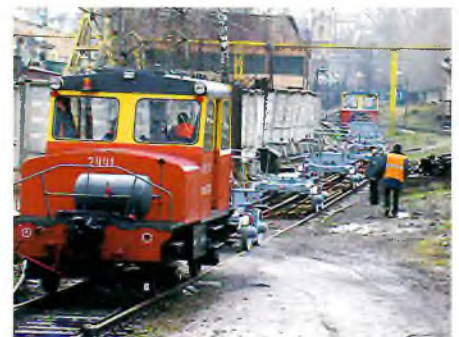
Рис. 1. Сцеп для перевозки длинномерных рельсовых плетей, оснащенный тележками ТР-4М и двумя мотовозами
