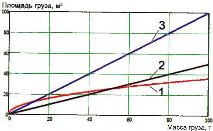
Рис. 3. Зависимость площади груза от его массы, определяемая различными нормативными документами: 1 – ГОСТ 1451-77; 2 – EN 13001:2004; 3 – DIN 15018:1984
