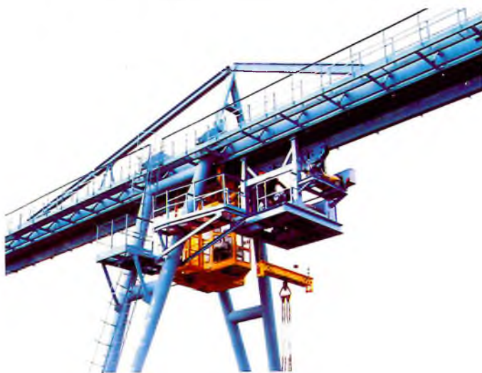
Рис. 6. Козловой кран грузоподъемностью 20 т Уфимского краностроительного завода
