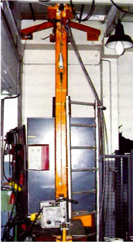
Рис. 2. Стенд для испытаний тяговых лебедок
