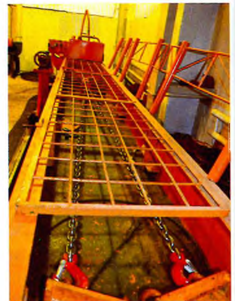
Рис. 1. Стенд для испытаний стропов производства 1980-х годов
