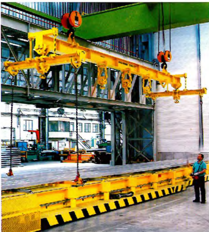
Рис. 3. Сложносоставная траверса, выполненная из типовых узлов и деталей с заменяемыми концевыми приспособлениями
